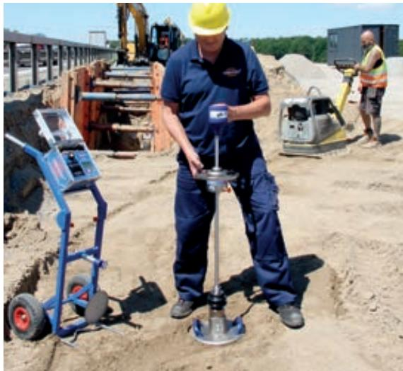
**Erbringen Sie Verdichtungsnachweise wirtschaftlich und effizient. Setzen Sie auf das kostengünstige und schnelle Messverfahren mit dem Leichten Fallgewichtsgerät TERRATEST 7000 STREAM!**
