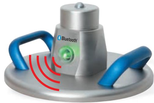
Mit TERRATEST 8000 WIRELESS können via APP vollwertige Messprotokolle sogar mit Google®-Maps-Foto der Messposition direkt von der Baustelle per Email versendet werden. Ausdrucke auf ausbleichendem Thermopapier gehören der Vergangenheit an. Für die Anwendung ohne Drucker bietet TERRATEST® preisgünstigere Gerätevarianten ohne externe Messelektronik an.
