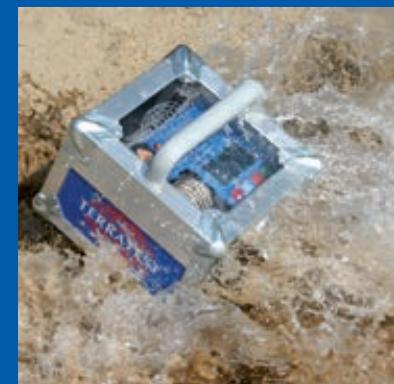
Der Messcomputer besitzt einen geprüften Schutzfaktor von IP43 gegen Staub und gegen eindringendes Wasser.
