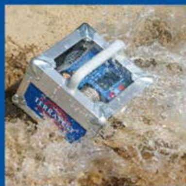
Der Messcomputer besitzt einen geprüften Schutzfaktor von IP43 gegen Staub und gegen eindringendes Wasser.
