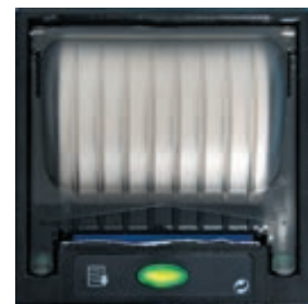
Während des Druckvorganges brennt die grüne Kontrollleuchte.
