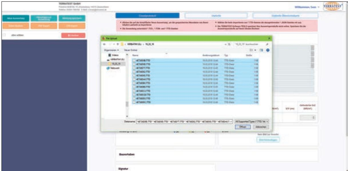
Nach dem Upload werden die Messdaten im linken Bereich als Messdatenliste mit Datensatznummer, Evd-Wert und Datum/Uhrzeit aufgeführt. Die Messdaten stehen nun zur Bearbeitung bereit.
