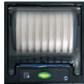
Während des Druckvorganges brennt die grüne Kontrollleuchte.
