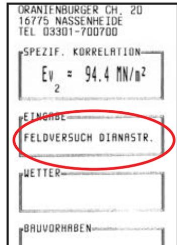
Die bestätigten Eingaben werden unter dem Feld „EINGABE“ auf den Protokollausdrucken und in der webbasierten Software „TEOLO“ im Feld „Bemerkungen“ dargestellt und abgedruckt.
