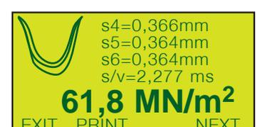
Das Gerät zeigt Ihnen nun nach Ausführung des 3. Messstoßes die Setzungen  $s_4$ ,  $s_5$  und  $s_6$  in mm sowie alle drei Setzungskurven an. Zusätzlich wird das Endergebnis vom Evd-Wert in  $\text{MN/m}^2$  dargestellt und durch Sprachausgabe das Ergebnis gerundet auf ganze Zahlen in  $\text{MN/m}^2$  angesagt.
