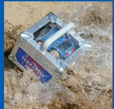
Der TERRATEST® Messcomputer besitzt einen geprüften Schutzfaktor von IP53 gegen Staub und gegen eindringendes Wasser.
